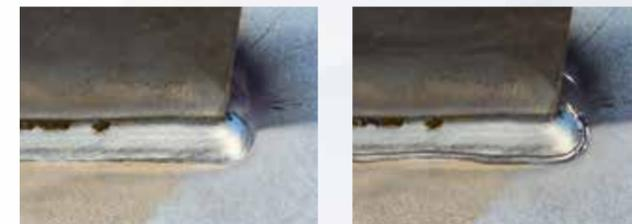
Antes / después: Gracias al método HiFIT, el límite de fatiga de la soldadura mejora entre un 80% y un 100%.
